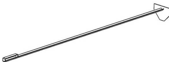
поз. 4 –Очиститель котла
